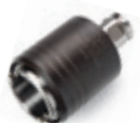
ZÁVITOVRTNÉ RYCHLOVÝMĚNNÉ SKLÍČIDLO VEL. 3 S UCHYCENÍM QUICKIN MAX/WELDON 32 Lze použít jen pro magnetické jádrové vrtačky s funkcí levotočivého chodu. Pro závitníky podle DIN 374/376, ve spojení se závitovými vložkami s bezpečnostní spojkou nebo bez bezpečnostní spojky M 22 - M 36.
